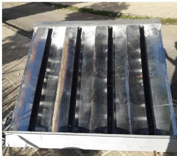
*Figure IV.25 : montage fini du capteur.*
