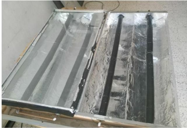
*Figure IV.26 : le capteur avec et sans vitrage.*
