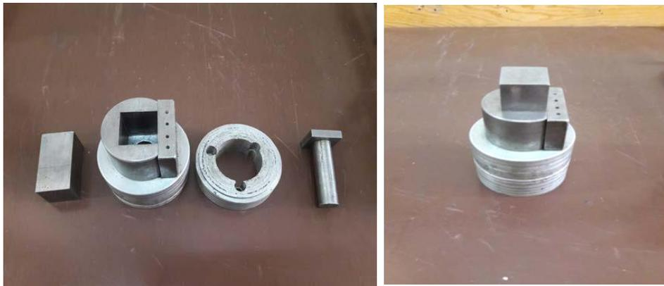
*Figure IV.7 : Fabrication des pastilles.*
