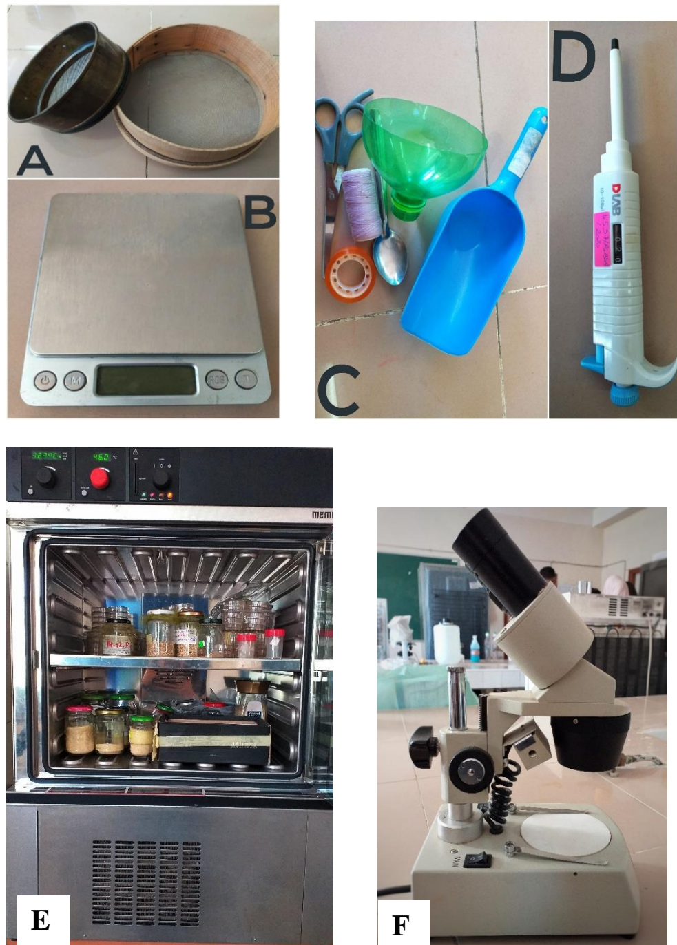
Figure 14: (A) tamis, (B) balance électronique, (C) autres matériels, (D) micropipette, (E) étuve obscure, (F) loupe binoculaire (Originale, 2022).
