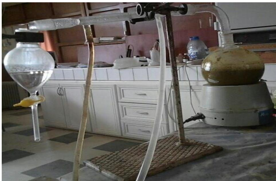
**Figure 14 :** Extraction des huiles essentielles de *P.lentiscus* par hydrodistillation.
