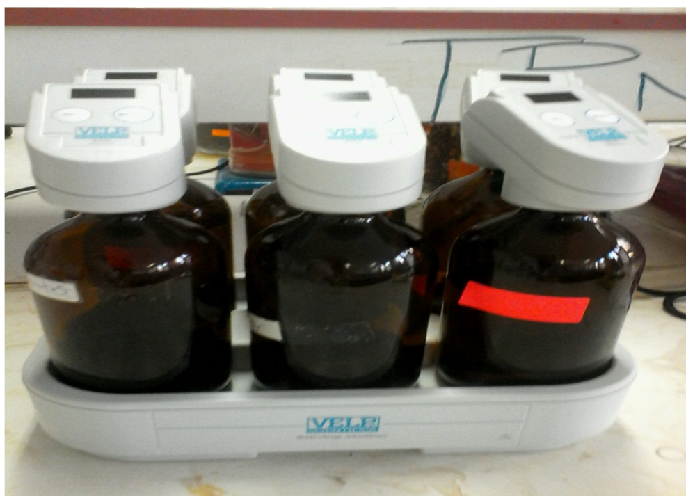
Figure II.5 : Photo du dispositif expérimental OxiTop mètre
