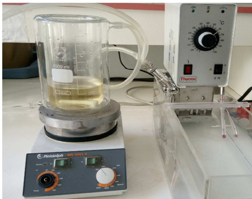
Figure II.3 : Photo du réacteur Fenton utilisé
