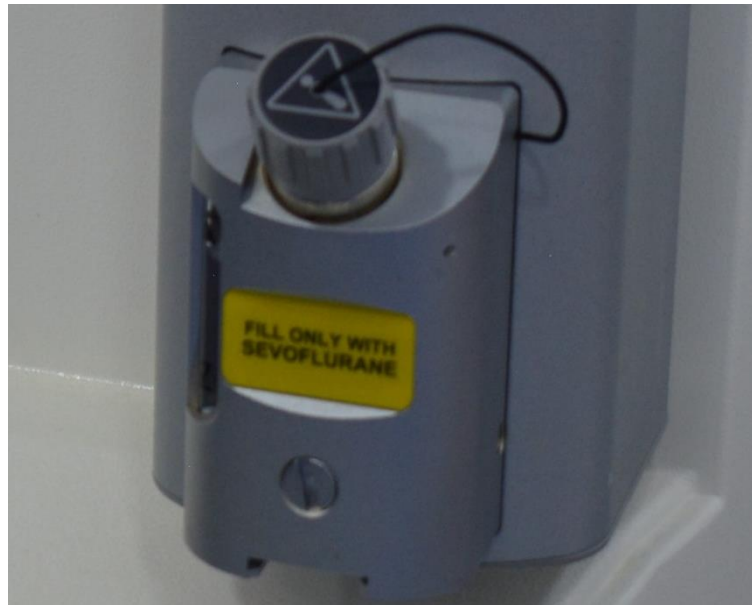
Figure 37: Instruction citée sur le vaporisateur de la machine d'assistance à l'anesthésie dédié au Sévoflurane, en Anglais : Fill only with sevoflurane (remplir uniquement avec du Sévoflurane)
