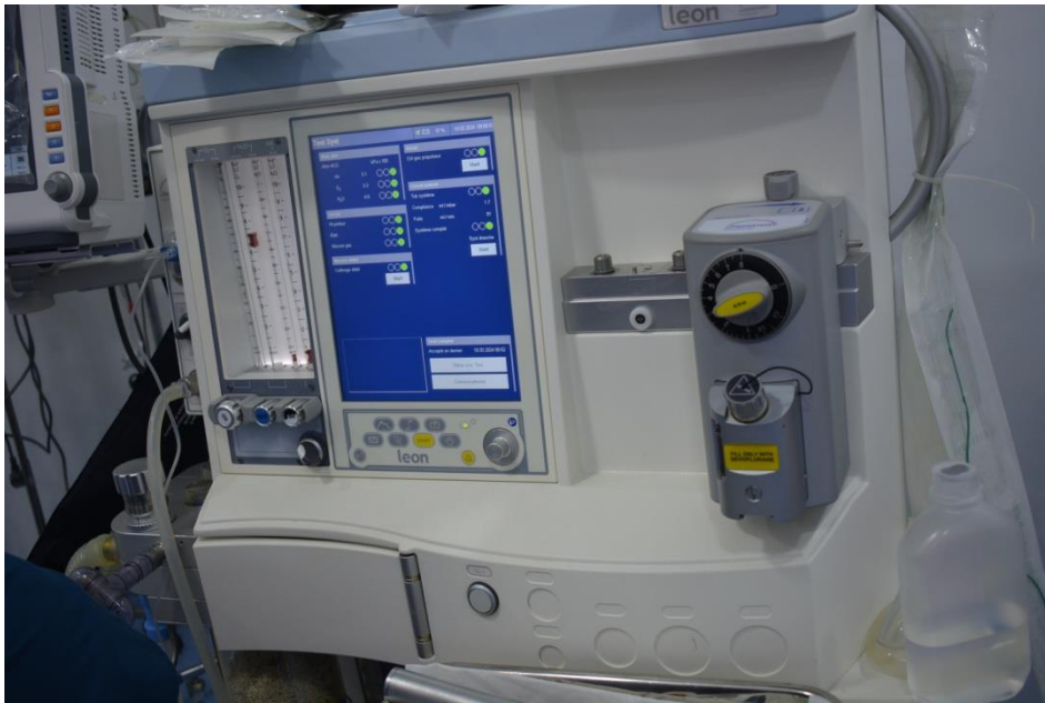
Figure 45: Station d'anesthésie sur chariot avec système d'évacuation de gaz anesthésique, monitoring et ventilateur.
