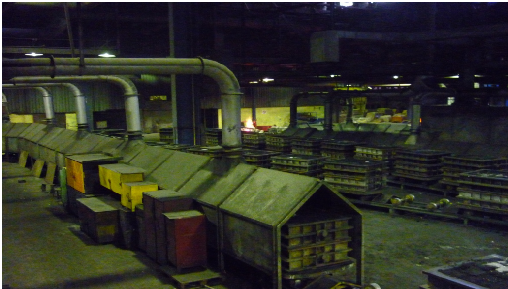
Figure I.6: image réelle du tunnel de refroidissement.
