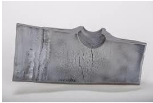
Figure II.3.6.1 : Corrosion sous contrainte
