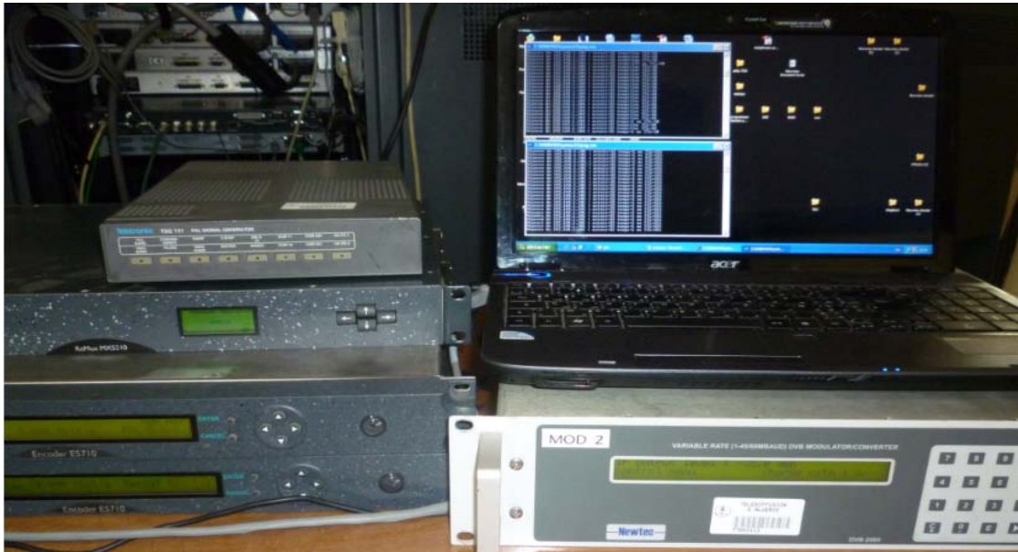
Figure III.33. Montage permettant de voir l'occupation spectrale en fonction du débit
