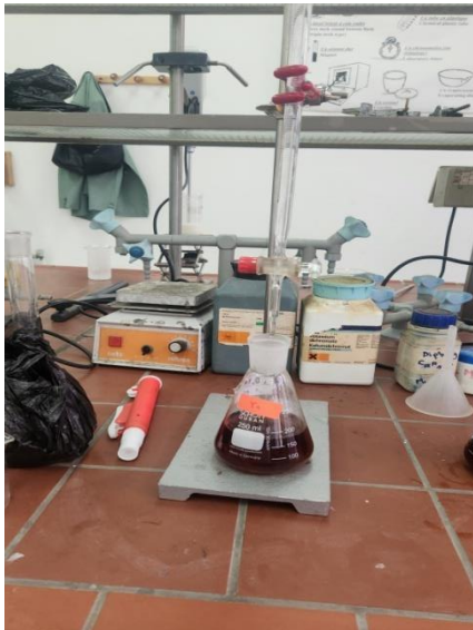
Figure 18 : Après ajout de 1.5 de NAF et 1ml H 2 SO 4 , on titre avec la solution de sel de Mohr 0.2N
