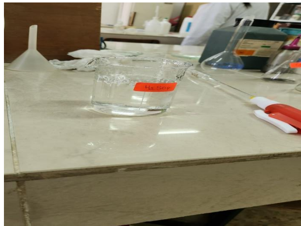
Figure 13 : Ajouter 30ml d'acide sulfurique concentré (H 2 SO 4 )
