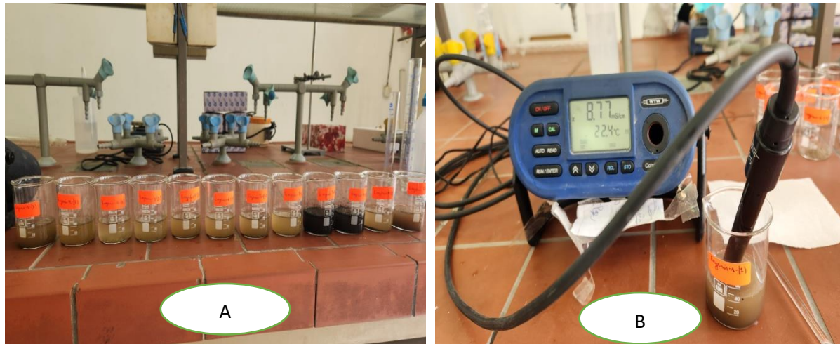
Figure 06 : Mesure de la conductivité électrique après dissolution des échantillons (Original, 2025).
