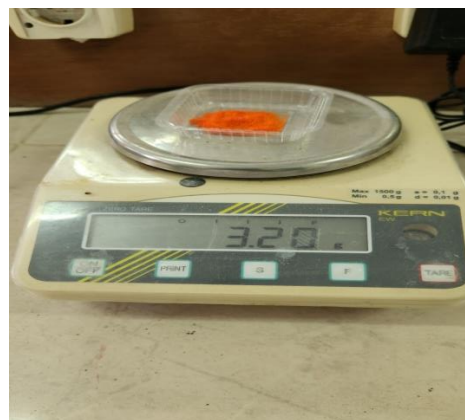
Figure 10 : Mesure de 3.2 g de Bichromate de potassium
