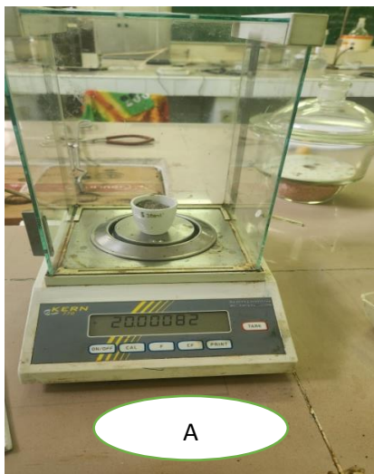
Figure 09 : pesé et mise à dessiccateur des échantillons respectivement (Original, 2025).
