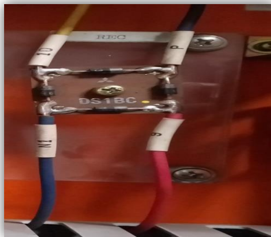
Figure 13. Pont de diode.
