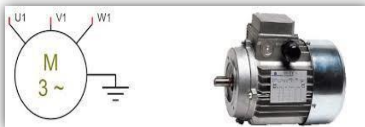
Figure 20. Symbole d'un moteur asynchrone triphasé.
