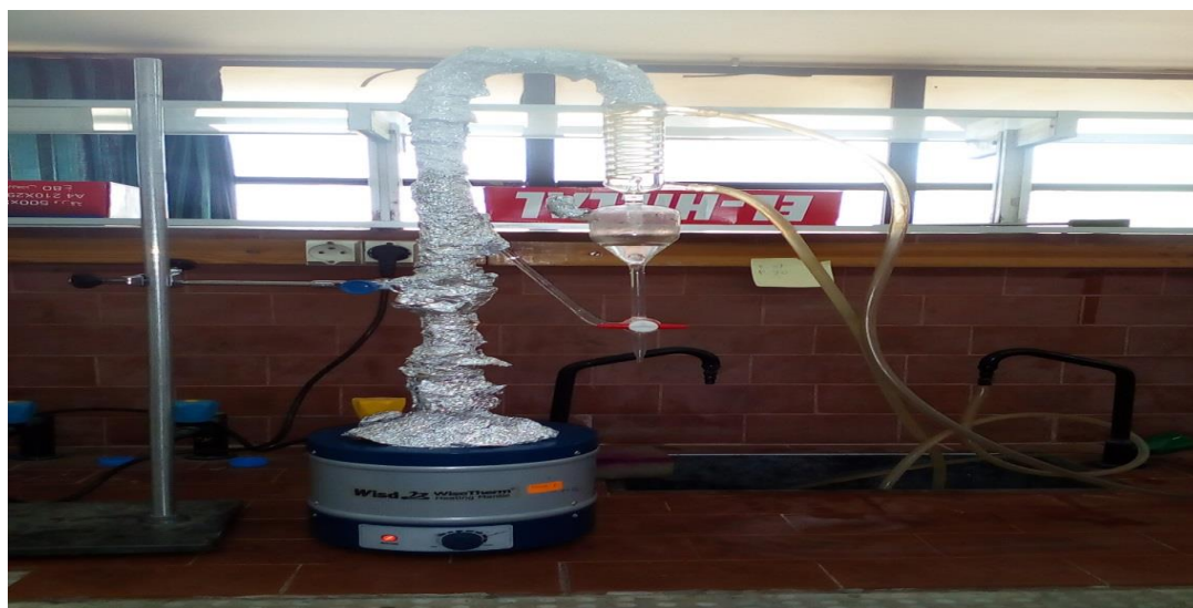
Figure 5 : Montage d'hydro distillation utilisé
