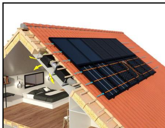
Figure III.40. Fonctionnement d'un panneau solaire aérothermique.
