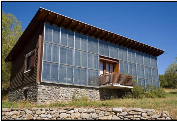
Figure III.24. Maison avec mur trombe. Source : www.bc-maison-ecologique.fr
