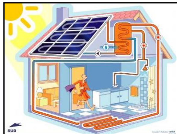
Figure III.39. Fonctionnement d'un panneau solaire thermique.
