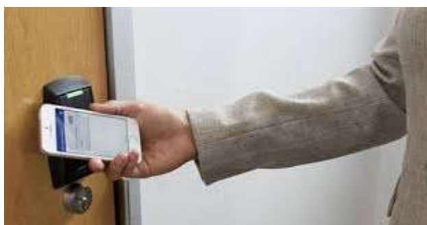
Figure I. 12. Contrôle d'Accès par Identifiants Mobiles
