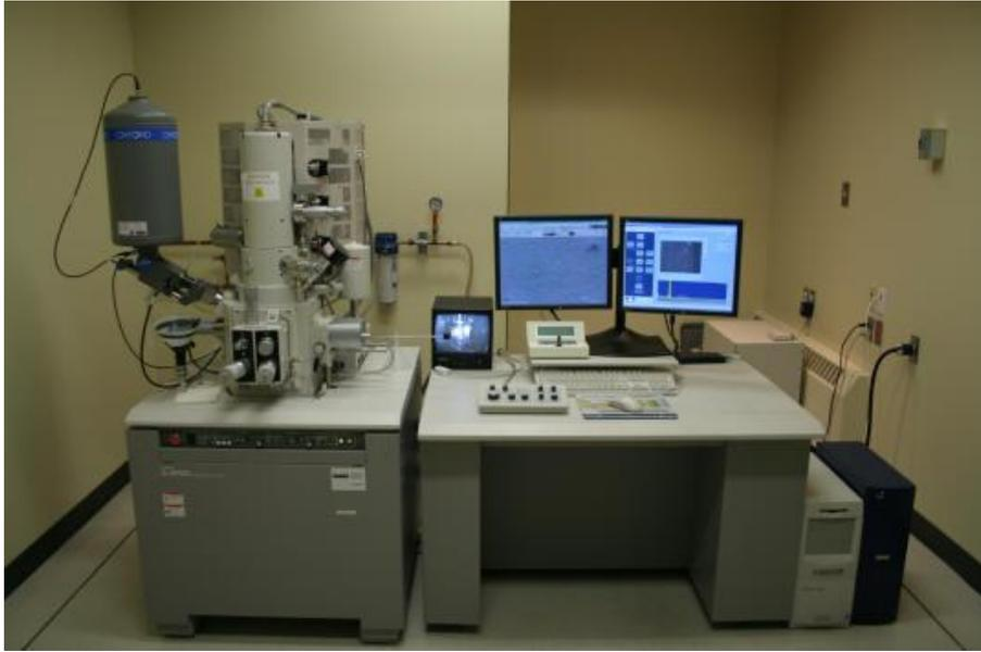
**Fig.II.7** Photographie d'un microscope électronique à balayage FEG-SEM
