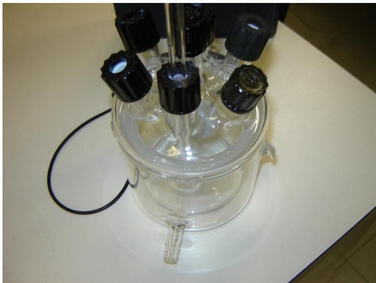
*Fig.II.2 Cellule électrochimique et couvercle à plusieurs orifices*
