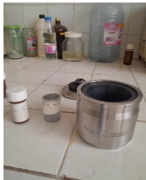
Figure II-3a : Conteneur du broyeur
