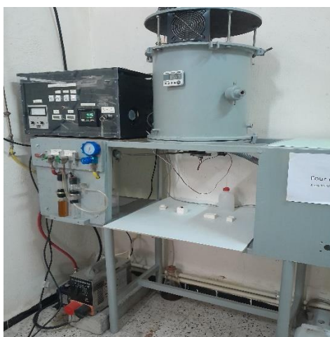
Figure II-6 : Four de frittage sous atmosphère contrôlée
