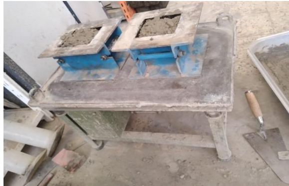
Fig.12 : vibration du béton
