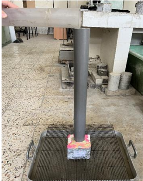
Figure III. 18: Essai de perméabilité à l'eau.
