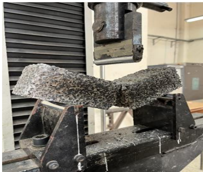
Figure IV. 8: Essai d'écrasement à la flexion trois points.
