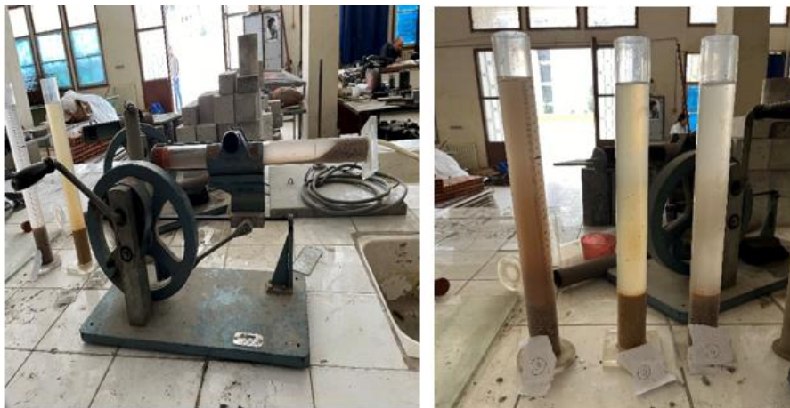
Figure III. 8: L'essai d'équivalent du sable.
