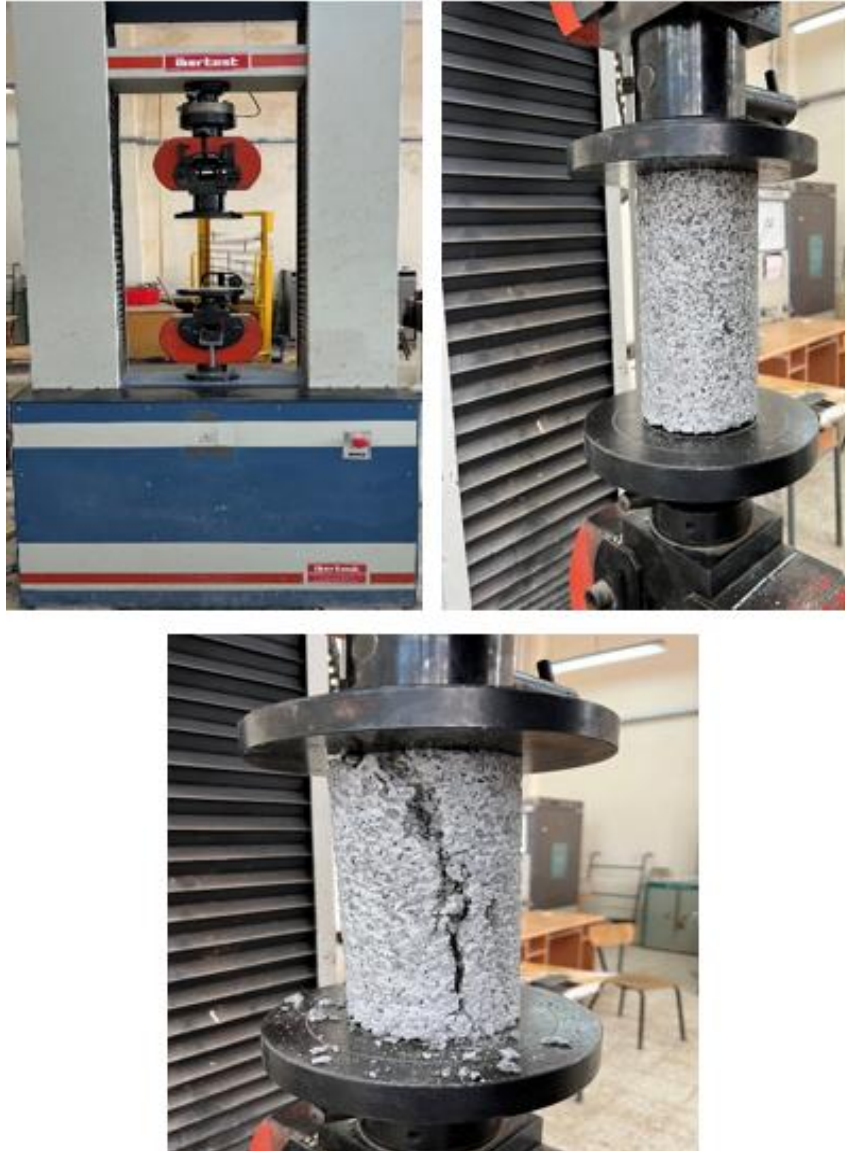
Figure III. 16: Dispositif expérimental pour l'essai de compression.
