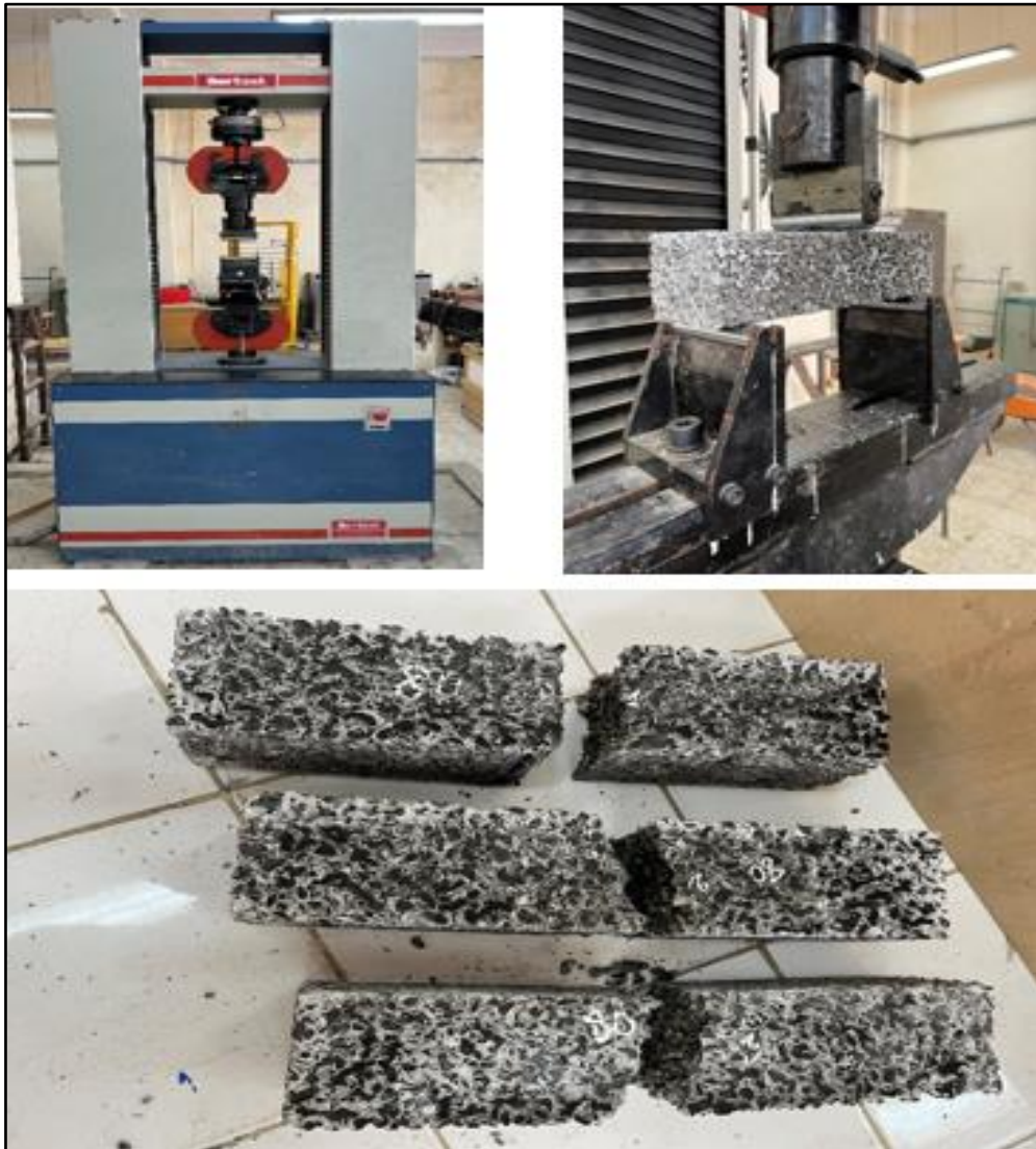
Figure III. 15: Dispositif expérimental pour l'essai de traction par flexion 3 points.
