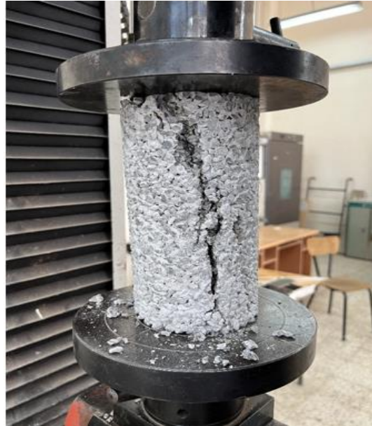
Figure IV. 4: Essai d'écrasement à la compression.
