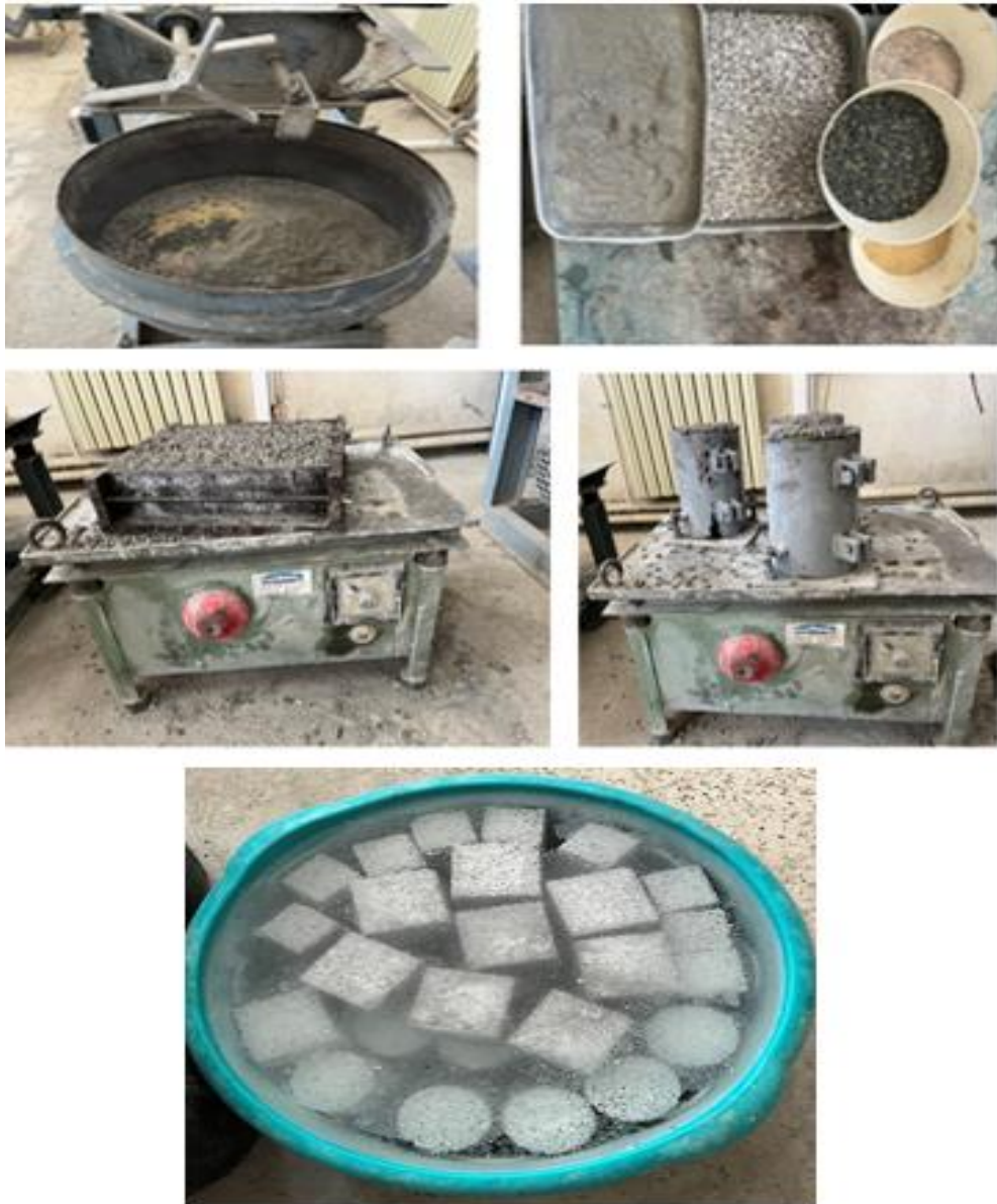
Figure III. 14 : Les différentes étapes de fabrication des éprouvettes.
