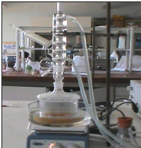
**Figure IV.2.** Système de l'extraction de la pectine (montage à reflux).
