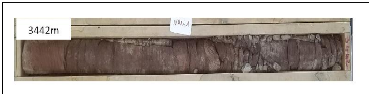
Figure 36: Photo de la carotte qui, illustre la dernière section de T1 dans le puits NHN-1.
