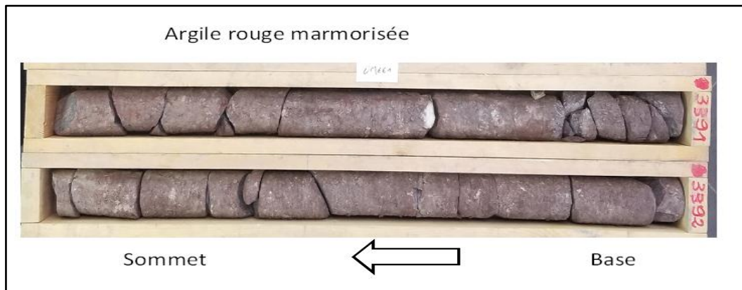
Figure 46: Photo de la carotte qui illustre la première section de T1 dans le puits OMEE-1.
