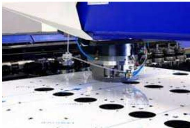
Figure I.17 : Poinçonnage.
