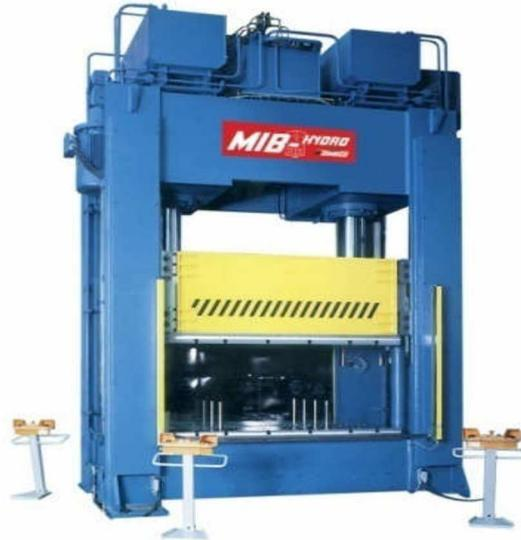
Figure II.6 : Presse à triple effets
