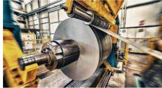
Figure I.7 : Laminage à froid.
