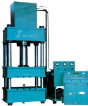
Figure II. 4 : presse à simple effet
