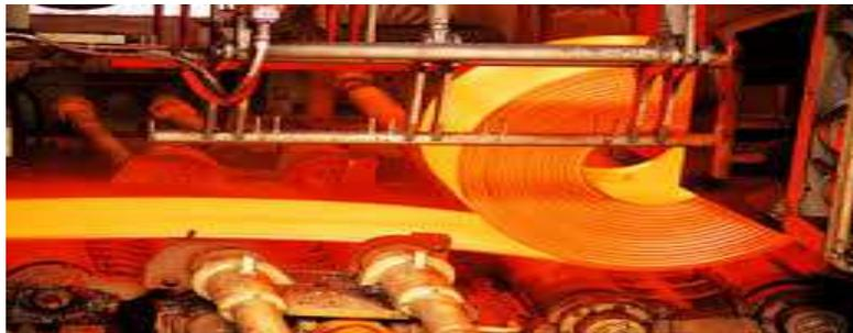
**Figure I.5 : Laminage à chaud.**
