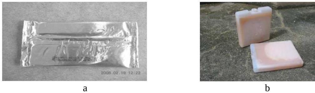
Figure II.4 : a) Conditionnement des MCP en sac aluminium, b) en briquette plastique.
