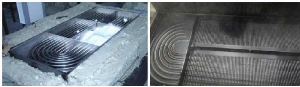
Figure II.6: Echangeur tubes et calandre baigné dans un MCP (a) simple (b) avec ailettes [18].
