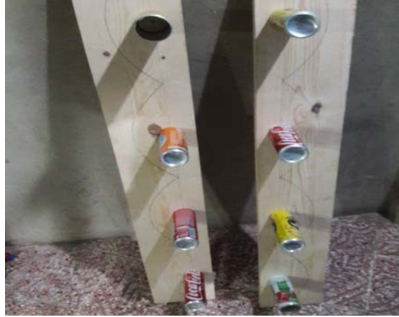
Figure.IV.17 : les supports pour fixer les tubes au foyer
