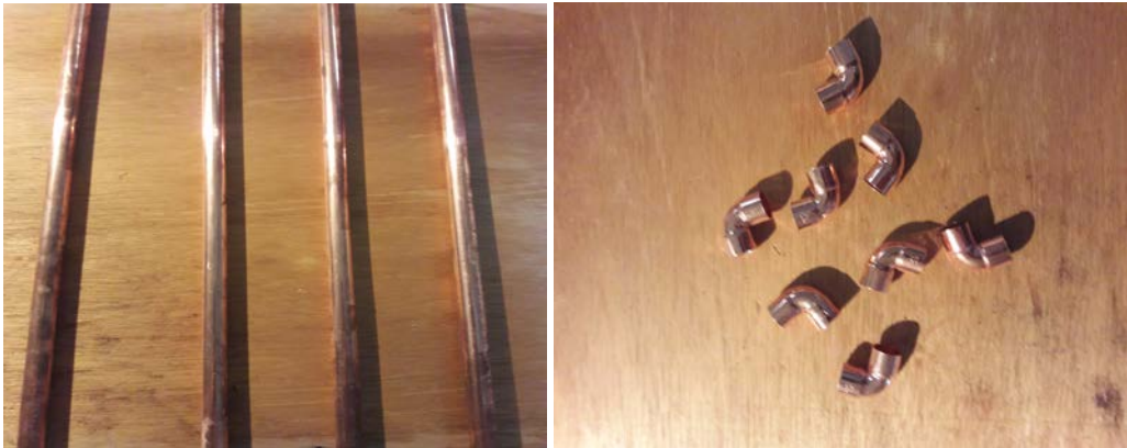
Figure IV.26 : les tubes et les coudes en cuivre de diamètre d=12\text{mm}
