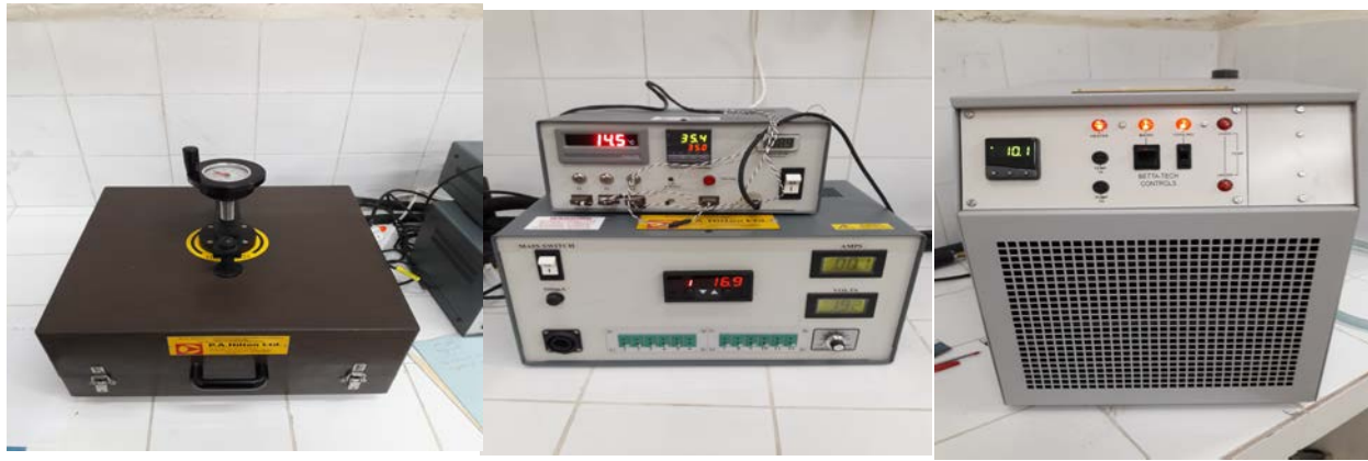
Figure IV.14 : Image globale de l'unité de mesure de la conductivité thermique
