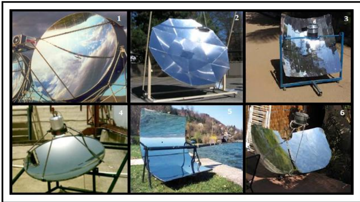
1-parabolique, 2-parabolique orienté vers le haut, 3-forme carrée concave, 4- sphérique, 5-cylindro-parabolique, 6-à parois réfléchissantes en forme d'aile. Figure III-17 : Les cuiseurs solaires à concentration [25]
