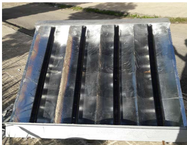
Figure IV.30 : montage fini de capteur.
