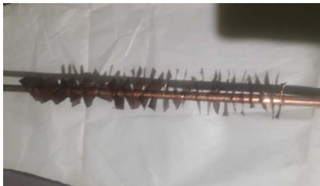
Figure IV.28 : tuyau avec des ailettes en cuivre.
