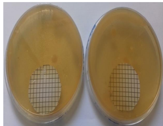
Figure 27: Représentation des boites de pétries correspondant à la recherche des Clostridium pour les eaux de forage
