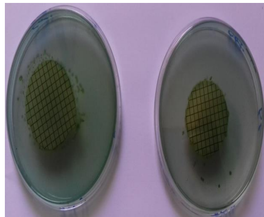
Figure 17: Représentation des boîtes de pétries correspondant à la recherche des CF
