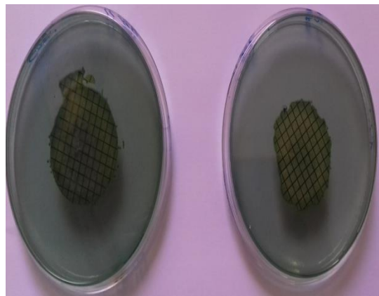
Figure 15: Représentation des boîtes de pétries correspondant à la recherche des CF 44°C pour l'eau du R1
