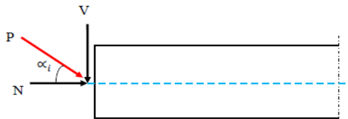
Fig. X.4: composantes de la force de précontrainte
