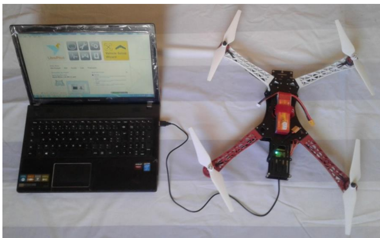
Figure V.20 Liaison du quadri-rotor au pc via le port USB
