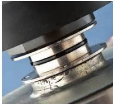
Figure 2. 18 Principe et appareillage de l'essai DSR
