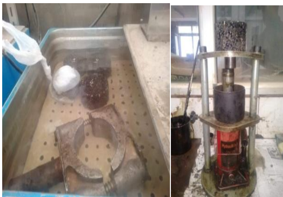
Figure 4. 25 Étape de l'essai Duriez réalisé
