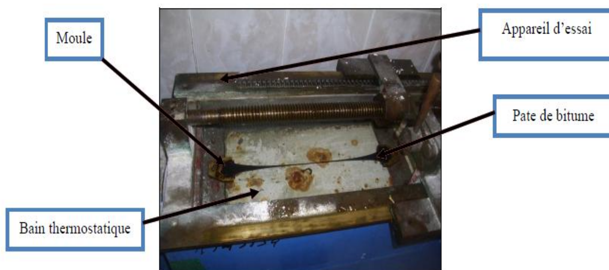
Figure 4. 13. Dispositif de l'essai de ductilité
