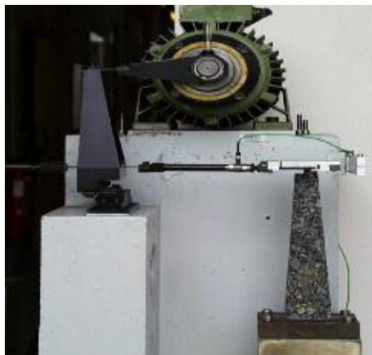
Figure 2. 31. Appareillage pour déterminer le module complexe
