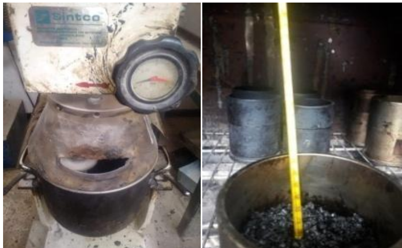
Figure 4. 23. Préparation de l'échantillon de l'enrobé bitumineux à base d'un bitume modifié
