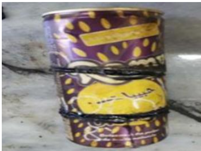
Figure 4. 14. Essai de compatibilité du bitume modifié
