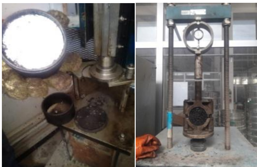
Figure 4. 24. Compactage et écrasement de l'échantillon
