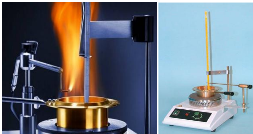
Figure 2. 14. Appareillage pour déterminer le point d'éclair et point de flamme
