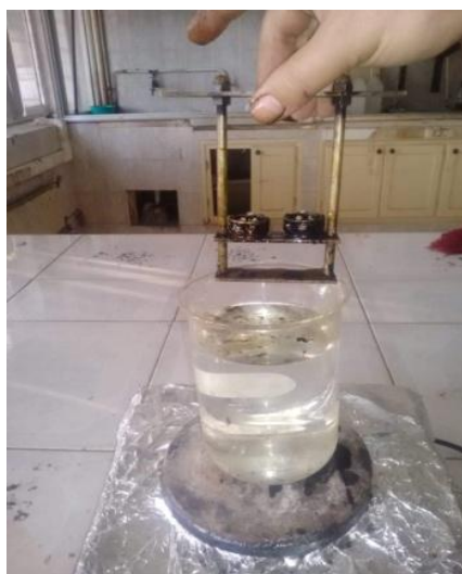
Figure 4.12. L'essai de point de ramollissement réalisé dans cette étude
