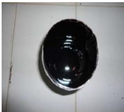
Figure 4. 8. Le bitume 40/50 à l'état liquide
