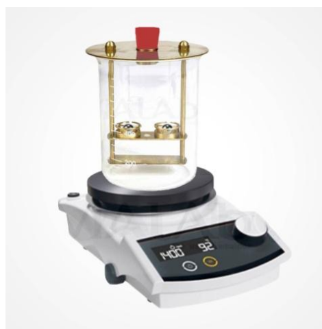
Figure 2. 11. Schéma de principe de l'essai TBA Figure 2. 12. Appareil manuel de l'essai TBA
