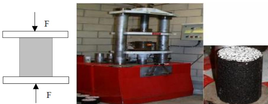
Figure. 2. 25 Schéma de principe et appareillage de la presse Duriez avec éprouvette
