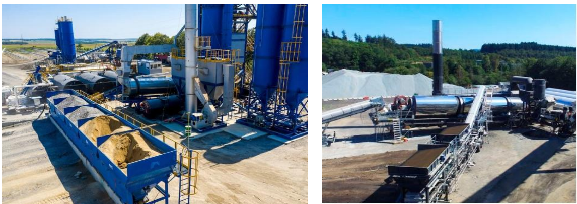
Figure. 2. 22 Exemple de centrales d'enrobage fixe et mobile.
