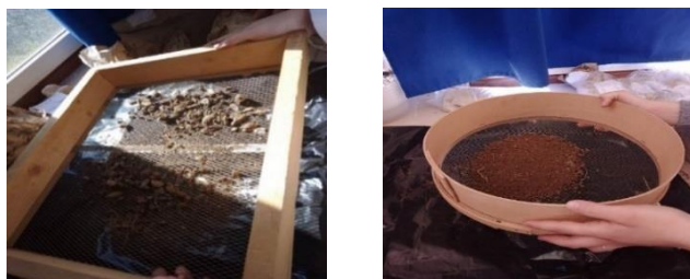
Figure 06 : Tamisage du sol à l'aide des tamis en mailles métalliques (Originale ,2023).
