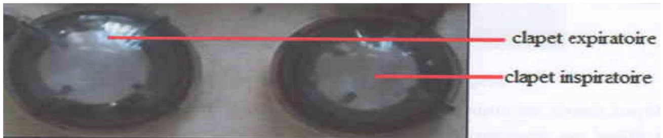
Figure III.16. Les clapets inspiratoire et expiratoire
