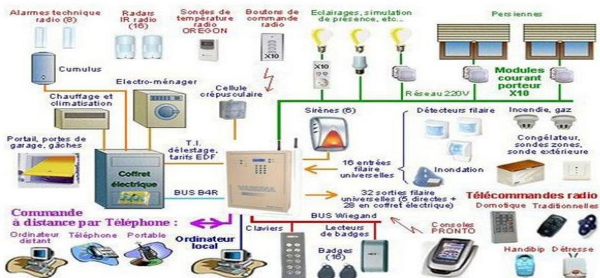
Figure I.2 exemple d'une installation domotique
