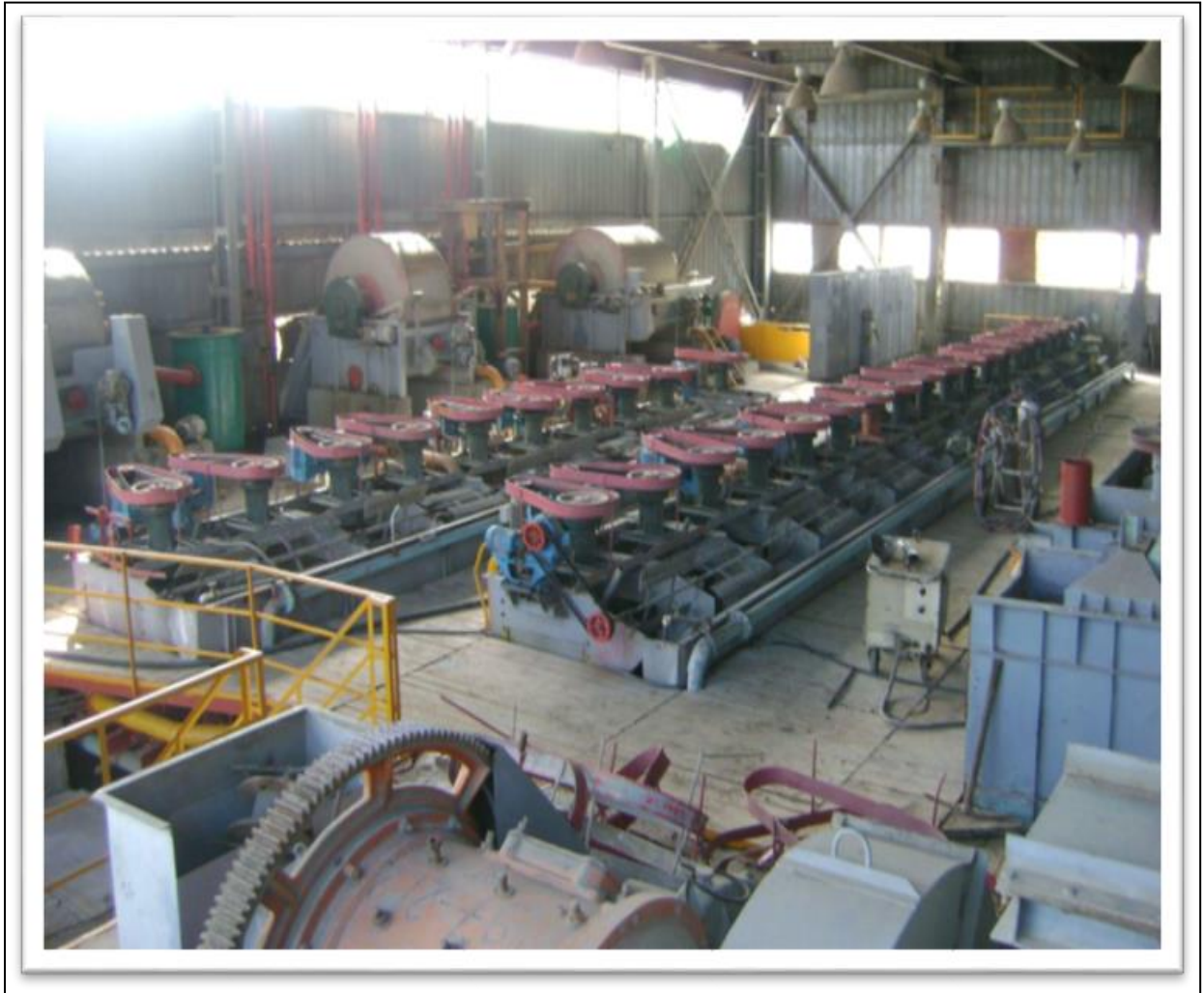
Fig.8 Cellules de flottation de la laverie du complexe minier de Kherzet Youssef
