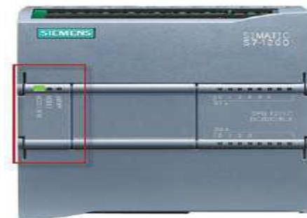
Figure IV.20:Signalisation de la CPU.
