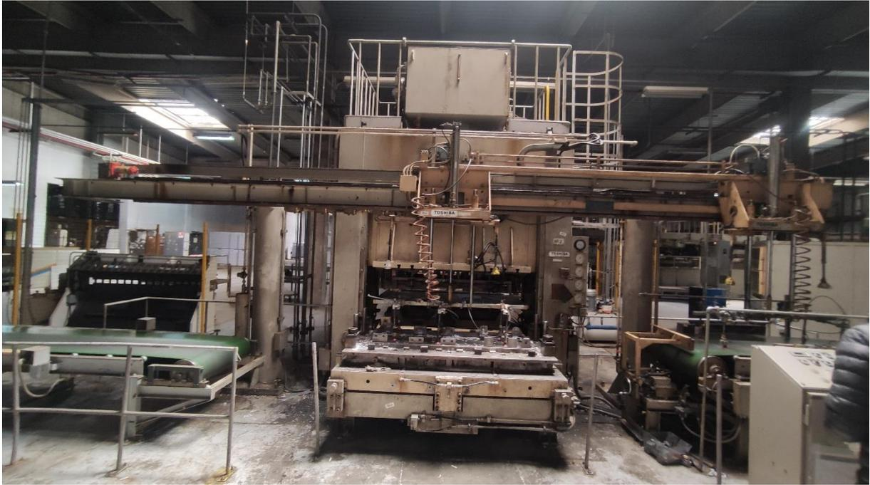
**Figure 7:** la presse hydraulique
