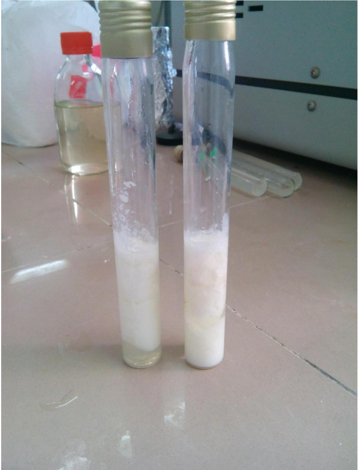
**Figure n°7** : lait standard coagulé par l'EEB
