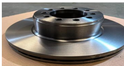
Figure I.8 : tambour et disque de freins en composite à matrice métallique [FTC1]
