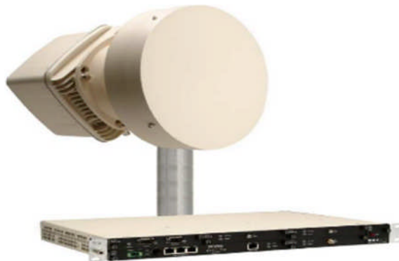
Figure 2-17: Equipements d'un FH
