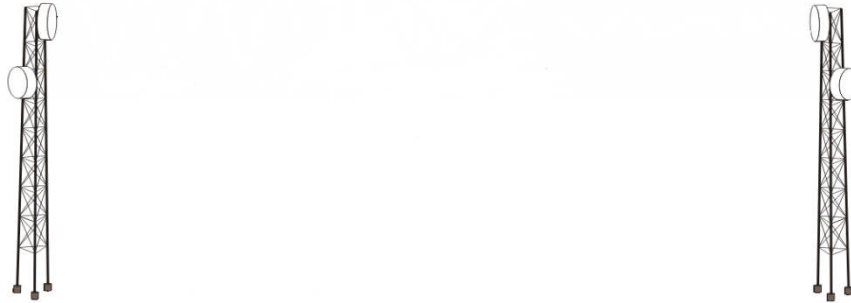
Figure 2-6 : faisceau hertzien à visibilité directe.
