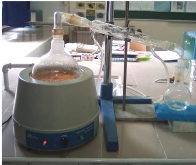
**Figure 10** : Dispositif d'hydrodistillation
