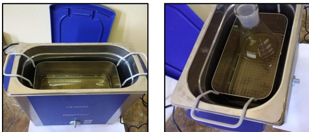
Figure 22 : Photographie de l'extraction dans un bain à ultrasons
