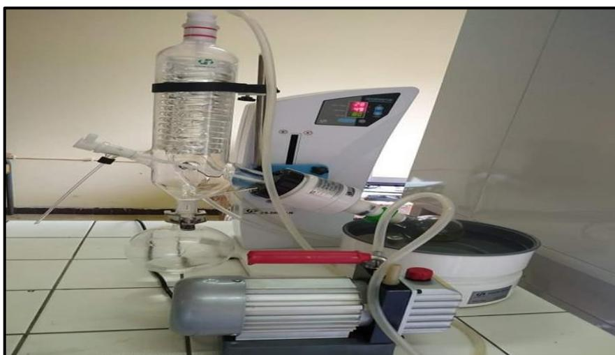
Figure 25 : Photographie d'un évaporateur rotatif
