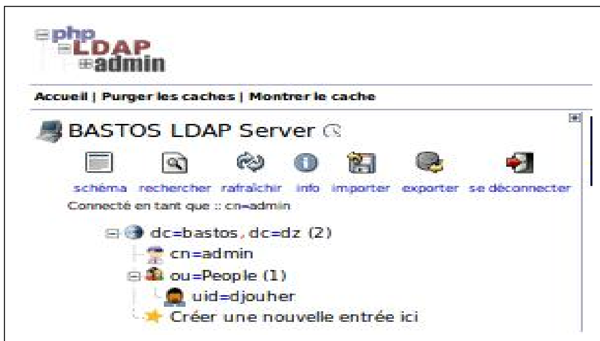
Figure III.30 : Création d'une nouvelle sous entrée.
