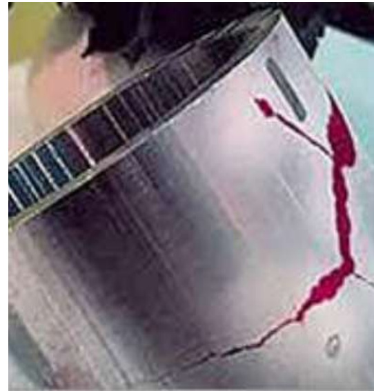
B) Visualisation de défaut sur cylindre par PT
