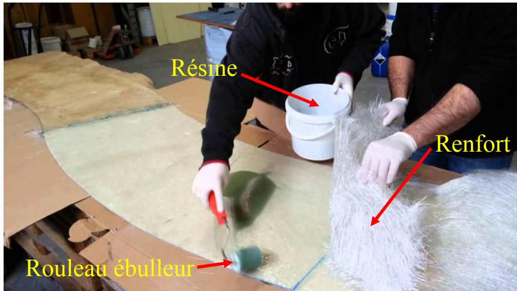
Figure IV.1 : Moulage au contact.
