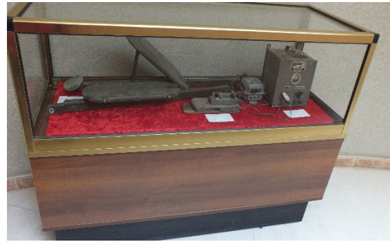
Figure 21 : Un Redresseur, un Transformateur, deux supports, Un Manipulateur.
