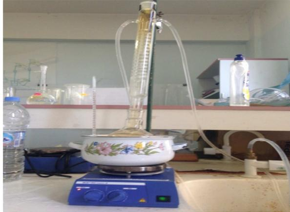
**Figure II.4 : Installation d'activation des boues**
