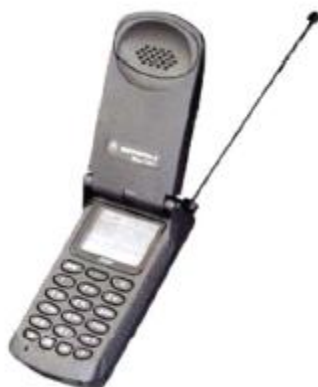
Figure (III.7) : Antenne monopolaire intégrée dans un téléphone mobile permettant la réception du GSM
