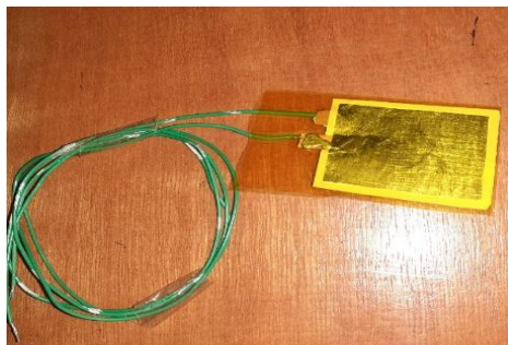
Figure III.3 : Capteur piézoélectrique de type composite.
