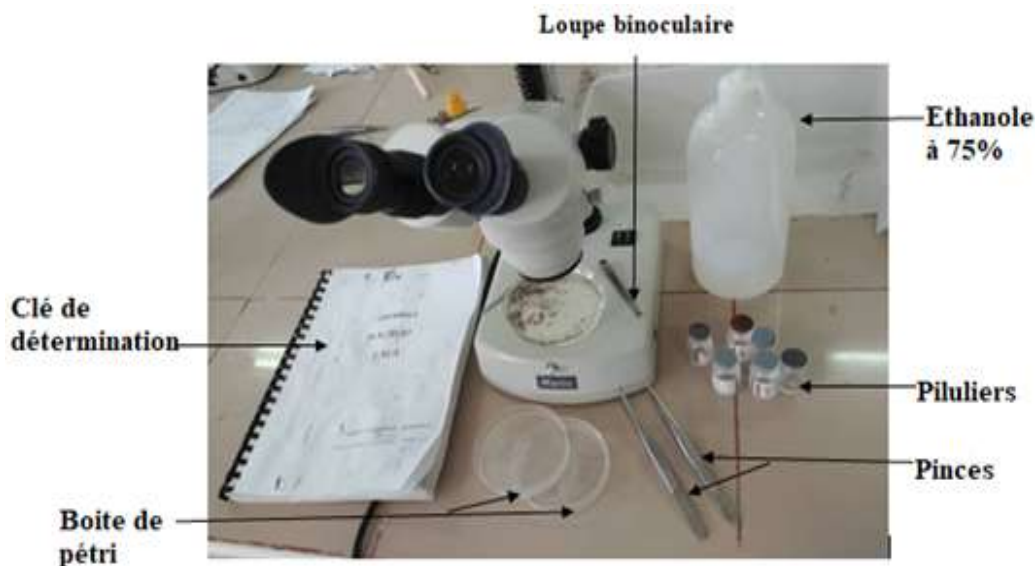
Photo 13 : Matériel utilisé pour le tri et la détermination au laboratoire.
