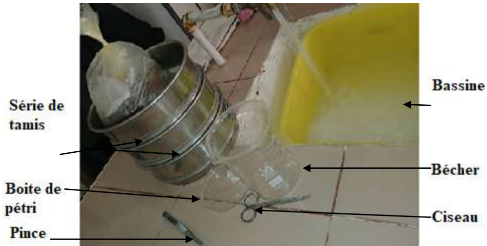
Photo 12 : Matériel utilisé pour le lavage au laboratoire.
