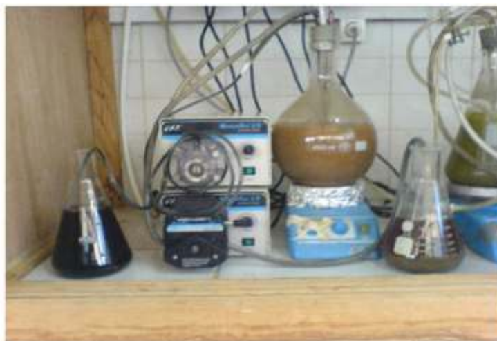
Photo 2 : Procédé du SBR couplé au système de coagulation-floculation
