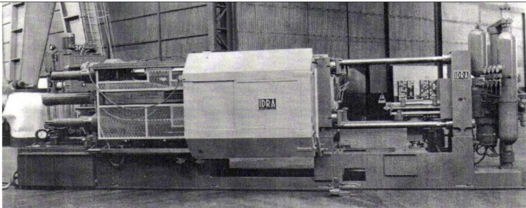
**Figure II.1.8** - Machine de moulage sous pression, IDRA série OL-380 S
