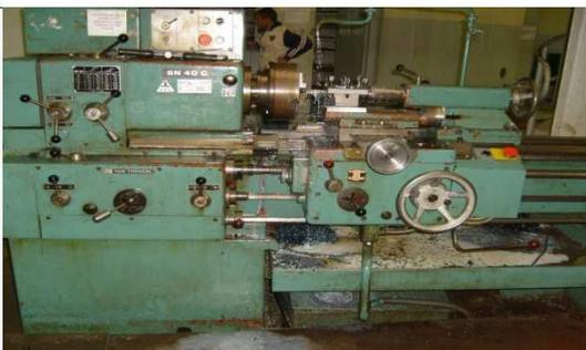
**Figure II.1.12** - Tour universel de type SN 40 SN 50C
