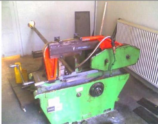
**Figure II.1.10** - Scie mécanique de type ALMOSMA3
