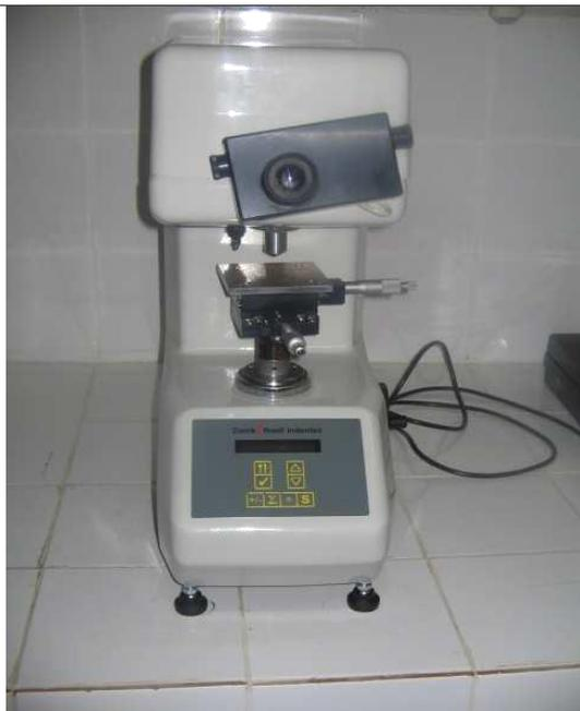
Figure II.1.24 – Microduromètre
