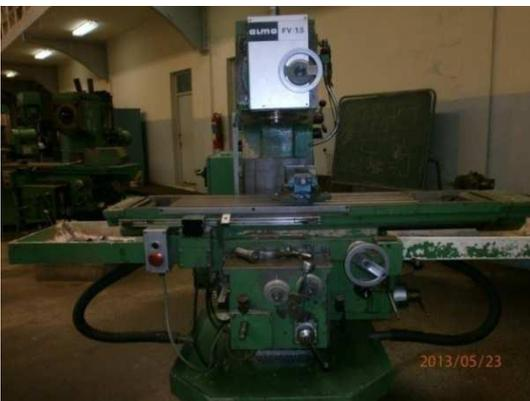
**Figure II.1.11** - fraiseuse verticale FV1,5 ALMO
