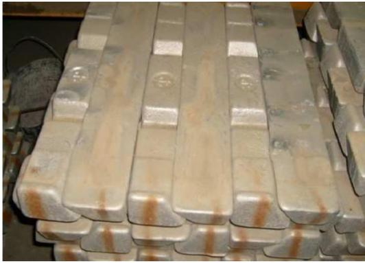
Figure II.1.1 - Lingots d'aluminium neufs
