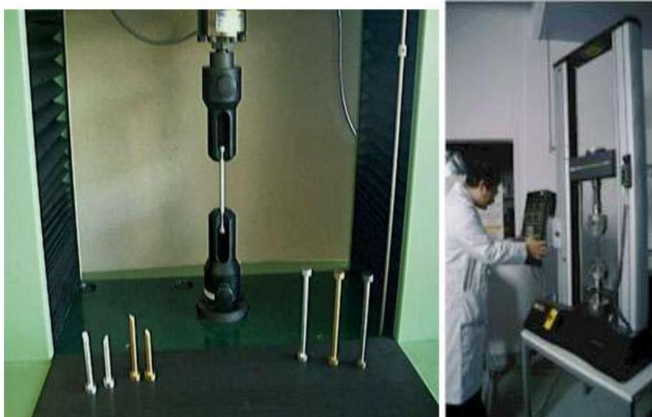
**Fig. I.4.1** : Machine de traction
