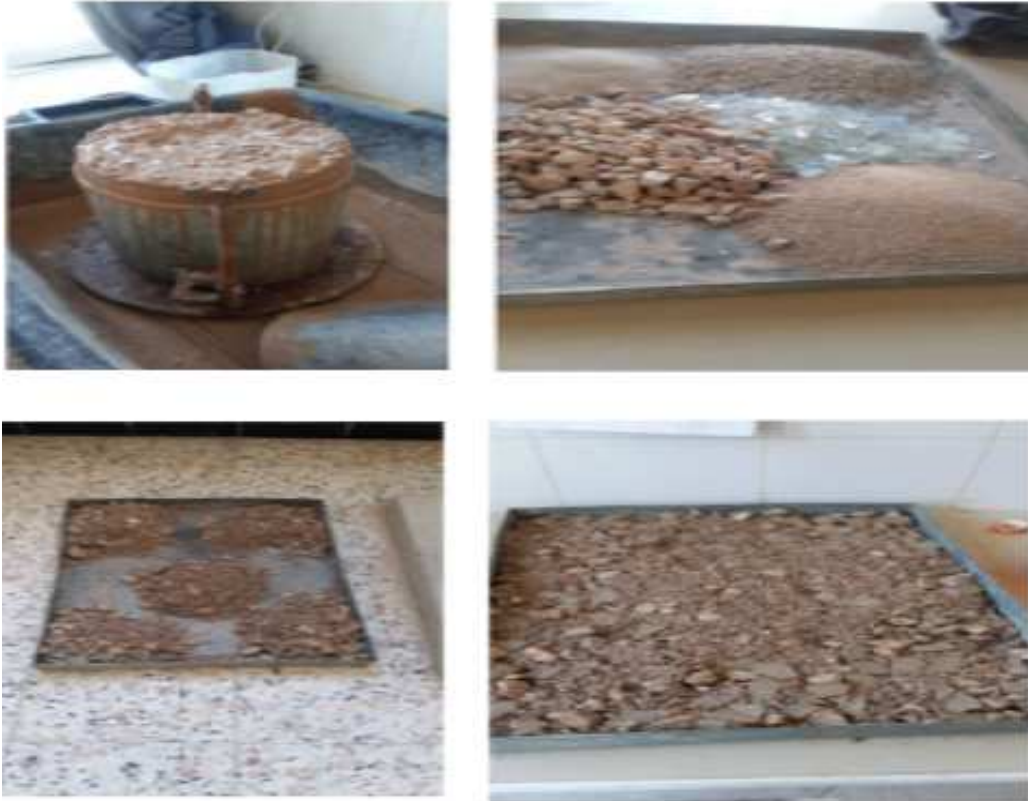
Figure 10.IV. Exécution de l'essai Proctor.
