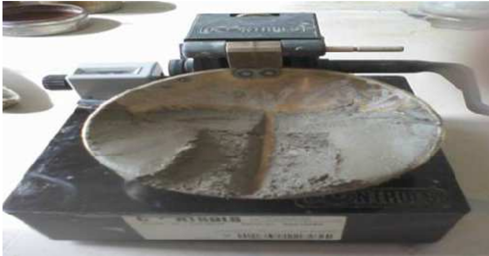
Figure 10.III. Détermination de la limite de liquidité w_l .
