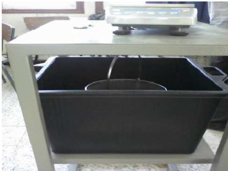
Figure 7.III. Appareillage utilisé pour pesée hydrostatique.
