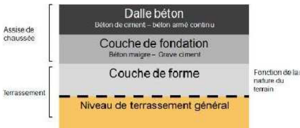
Figure 4.I. Construction d'une chaussée en béton de ciment.
