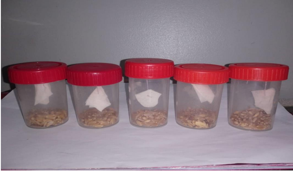
Figure 9 : Dispositif expérimental du test par inhalation des huiles essentielles de marjolaine et de menthe poivrée à l'égard des adultes de R. dominica (Originale, 2022).
