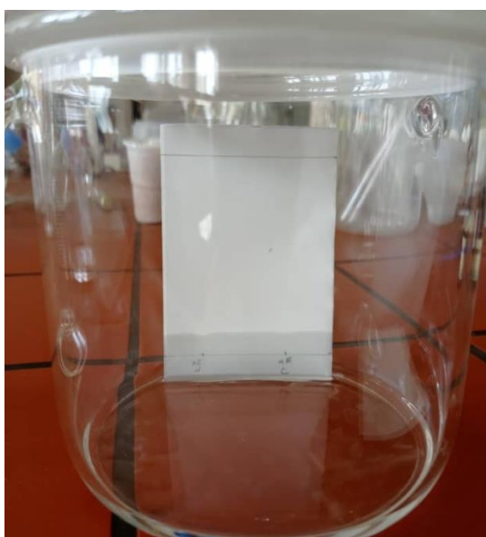
Figure 9 : La plaque CCM dans la phase mobile.
