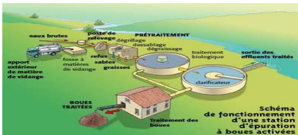
Figure N°05 : Fonctionnement d'une station d'épuration.
