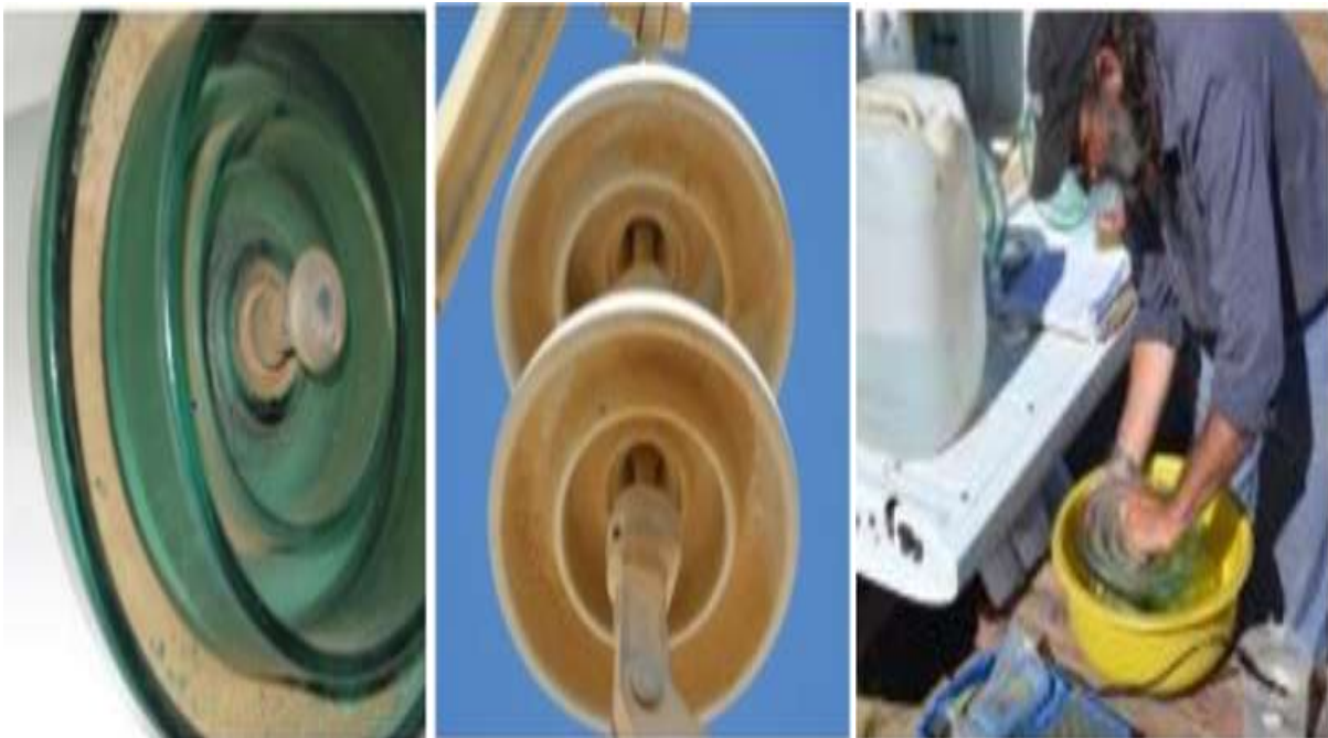
Figure II.1 : Pollution des isolateurs
